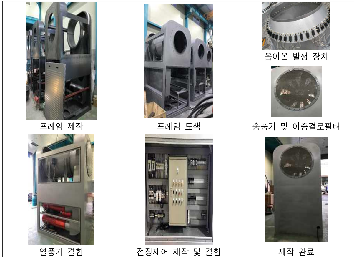
〈신청기술의 안개저감장치 설치 과정〉
