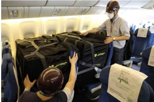
방염포장용기(CSB) 설치 현황
