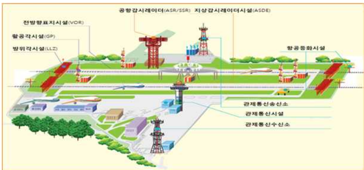
【 공항 내 항행안전시설 구축 및 운영 사례 】
