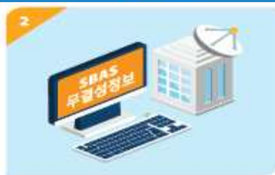
중앙처리국 : 보정·무결성정보 생성 기준국 데이터를 사용하여 보정정보와 무결성 정보를 생성 및 SBAS 메시지 생성
