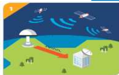
기준국 : GPS 신호 수집·전달 기준국에서 GPS 신호를 수신하고 항법메시지를 추출하여 중앙처리국에 전송
