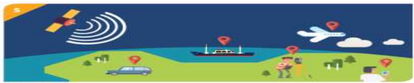
보정신호 활용 항공기·자동차 등에 설치된 수신기는 GPS 신호와 SBAS 신호를 동시에 수신하여 정확한 자기 위치 확인 (GPS 신호 및 SBAS 신호에 오류가 있을 경우에는, 6~10초 이내 경보신호를 제공하여 사용·급지를 자동 권고)
