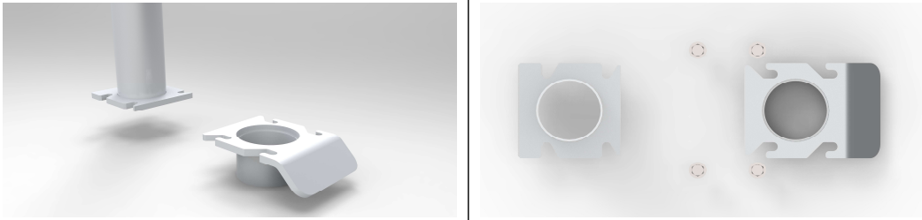
분리후 그림 1.1 정면 충돌 시 하부지주와 상부지주 분리 동작도
