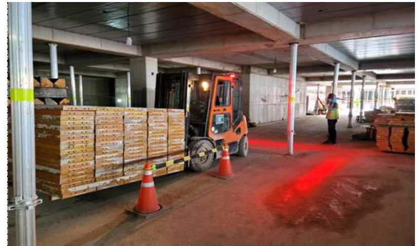
개선 후 지게차 측면 및 후면에 레이저 라인 빔을 부착하여 접근금지 조치
