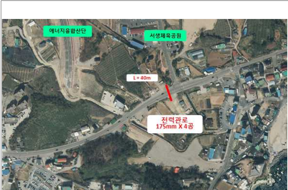
사진설명 서생면 신암리 산238-4 일원 전력관로 \Phi 175 \times 2\text{단}2\text{열} \times 40\text{M}
