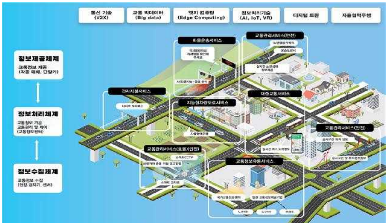
< 지능형교통체계(ITS) 구성 체계 및 운영 흐름 >
