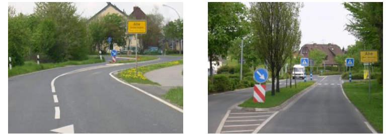
<그림 8.1> 도로 기하구조(선형) 변화 및 차로 폭 감소를 통한 자동차 주행속도 관리
