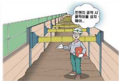
조립식 간이 흙막이 설치 또는 적정구배 준수
