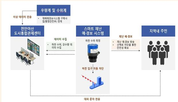
스마트 예·경보 서비스는 하천 수위계를 통해 수위 상승 시 하천 입구를 자동으로 차단하여 안전성을 확보한다. 또한 수집된 수위 데이터를 활용하여 재난 발생 사전 예측으로 재난 예·경보 방송을 송출하고, 저지대 거주 주민에게 문자를 전송하여 신속한 대피를 가능토록 할 예정이다.
