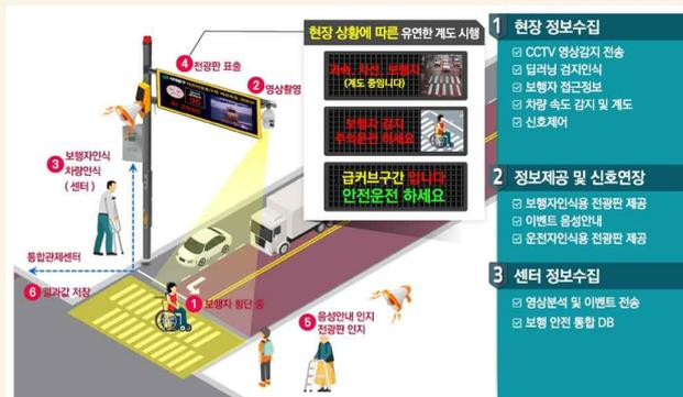
기존 교통 시설물에 지능형 CCTV, 속도 위반 경고장치 등을 구축한다. 과속차량, 사각지대 보행자 접근정보 등을 전광판에 표출하여 운전자의 안전한 운행을 유도한다. 음성 안내장치, 횡단보도 집중조명 등을 통해 보행자 안전을 확보하고, 비상벨 등 방법 장치를 결합하여 범죄예방 효과도 기대된다.
