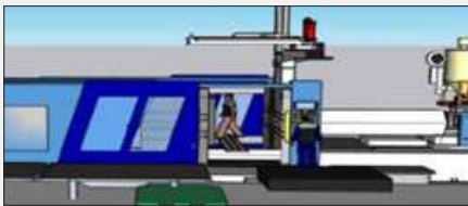
재해자가 사출성형기 내부에 대기한 상태
