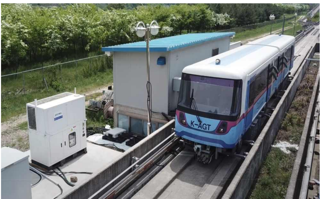
경전철용 무선급전시스템 (2020년, 한국철도기술연구원 개발)
