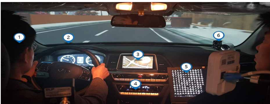
1 운전자 뇌파변화 감지 2 운전자 안구운동 추적 3 GPS 좌표 연동 4 실차와 동일한 공조 시스템 5 실시간 데이터분석 6 피실험자 모니터링 CCTV
