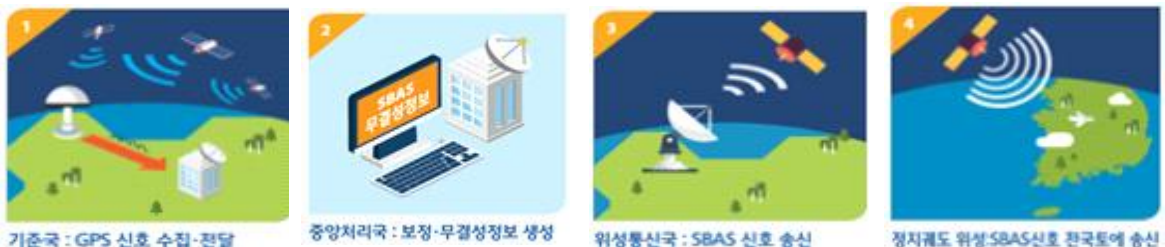
① GPS 위치정보 수신 ② 오차값 보정 및 보정값을 위성으로 송신 ③ 보정신호 위성 서비스
